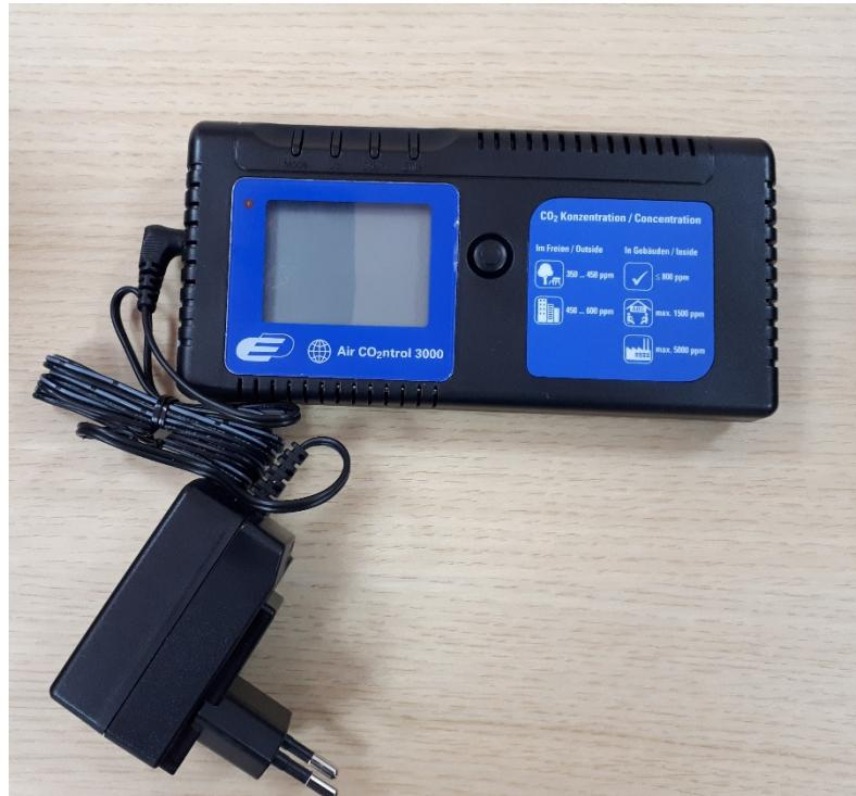
**Proizvođač i model:** DOSTMANN electronic, model: AirCO<sub>2</sub>ntrol 3000
